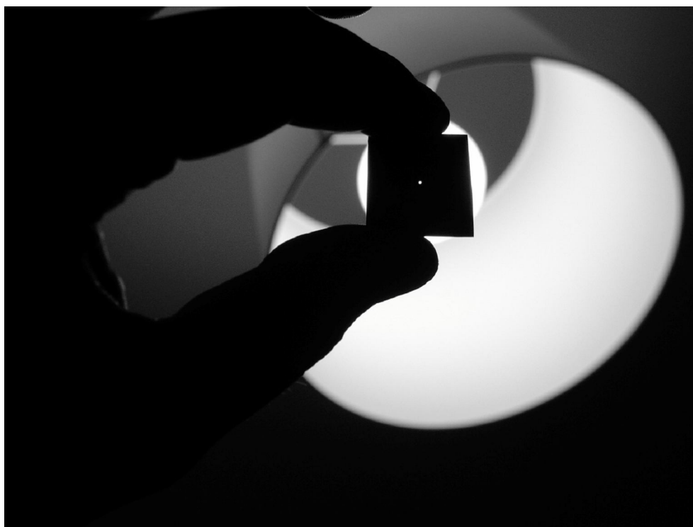
Rys. 21 Otworek w cienkiej blaszce widziany pod światło. W rzeczywistości średnica otworka (0.27 mm) jest znacznie mniejsza, niż mogło by to się wydawać na podstawie zdjęcia. Całkiem niezłej jakości otworek wykonany przy pomocy igły.
